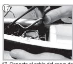
la aleta izquierda en el canal 4 del receptor y el cable del variador en el canal 3.
