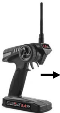
4. Drücken des Abzugs (Bremsen)
