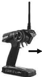
4. Drücken des Abzugs (Bremsen)
