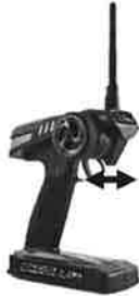
5. Dejar de nuevo en neutro (activa el variador)
