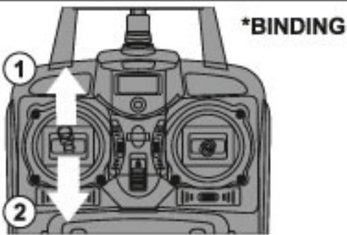
Esperar entre 5 y 7 segundos para estabilización del giroscopio antes de realizar el binding (parpadeo lento).
